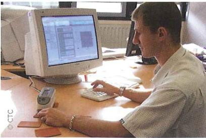
Photo 3 : spectrophotomètre de type laboratoire (Minolta).
