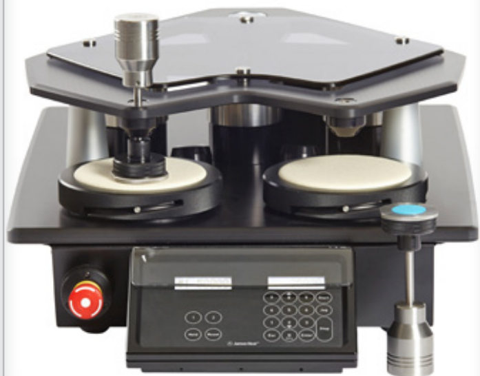
EN 388 § 6.1 TESTS D'ABRASION
