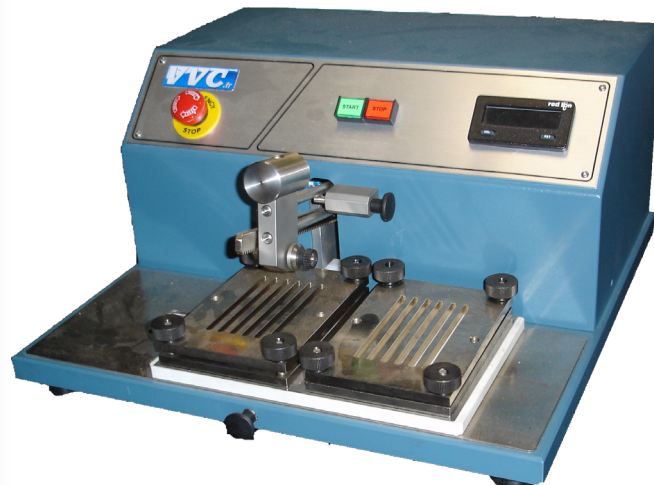
EN 388 § 6.2 TESTS DE RÉSISTANCE A LA COUPURE
