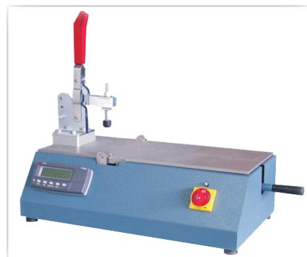
Après avoir serré la chaussure, par sa semelle, à la table de test, une force de 30N est appliquée sur le plan de la table métallique. L'angle de flexion est alors affiché et tous les échantillons dont l'angle est supérieure à 45° de l'horizontale sont sujet au test de flexion.
