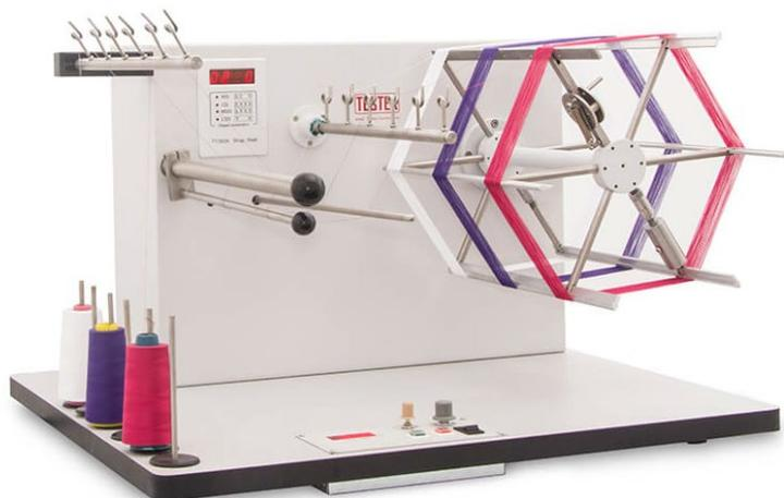
Le dévidoir TY360A permet de produire des échevettes d'une longueur souhaitée.
