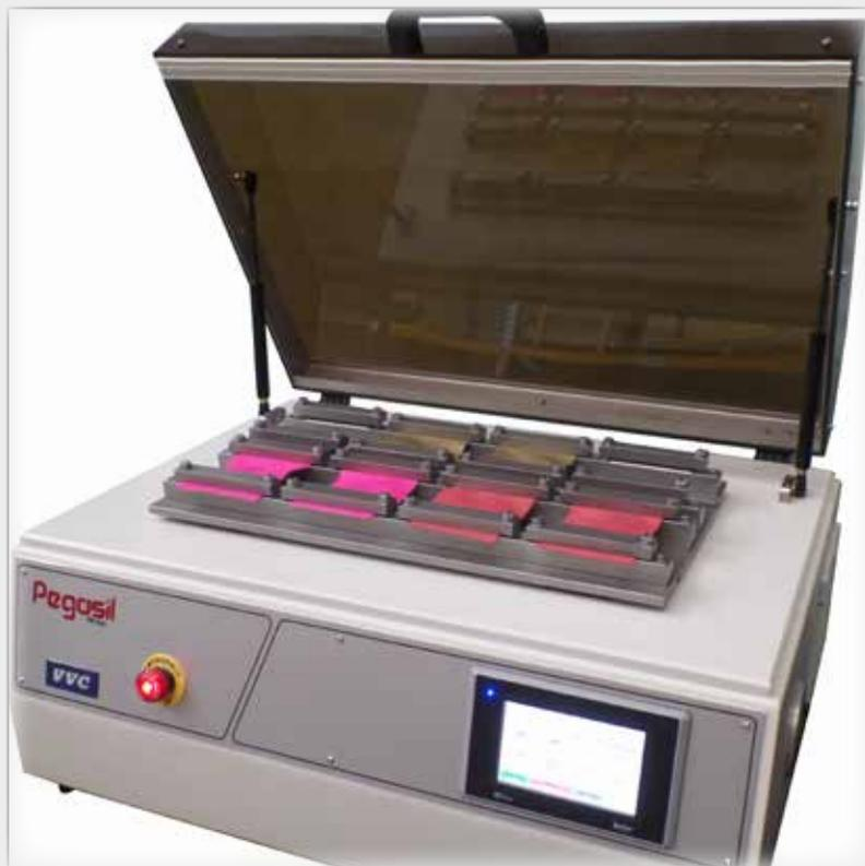
Le flexomètre est utilisé pour évaluer la formation de craquelures dans la zone de flexion de la chaussure durant son utilisation.
