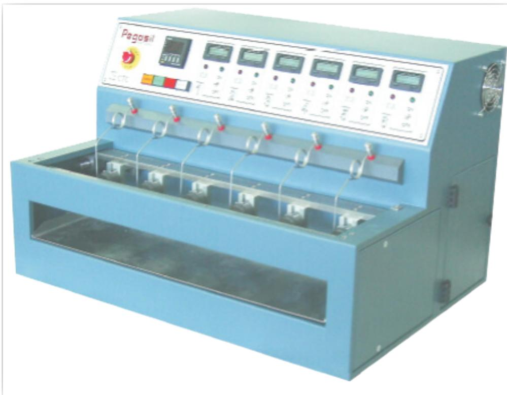
Le Pénétrromètre Bally permet de tester le résistance à la pénétration de l'eau dans des cuirs soumis à la flexion. Cette machine est très souvent utilisée pour tester l'imperméabilité des cuirs de dessus. Le principe est de soumettre l'échantillon à une flexion répétée jusqu'à ce que l'eau transperce.
