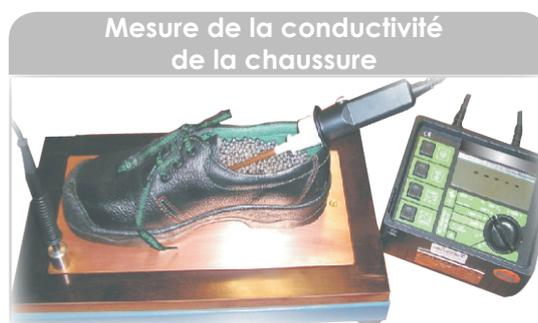
Cet appareil mesure la résistance électrique des chaussures après conditionnement.
