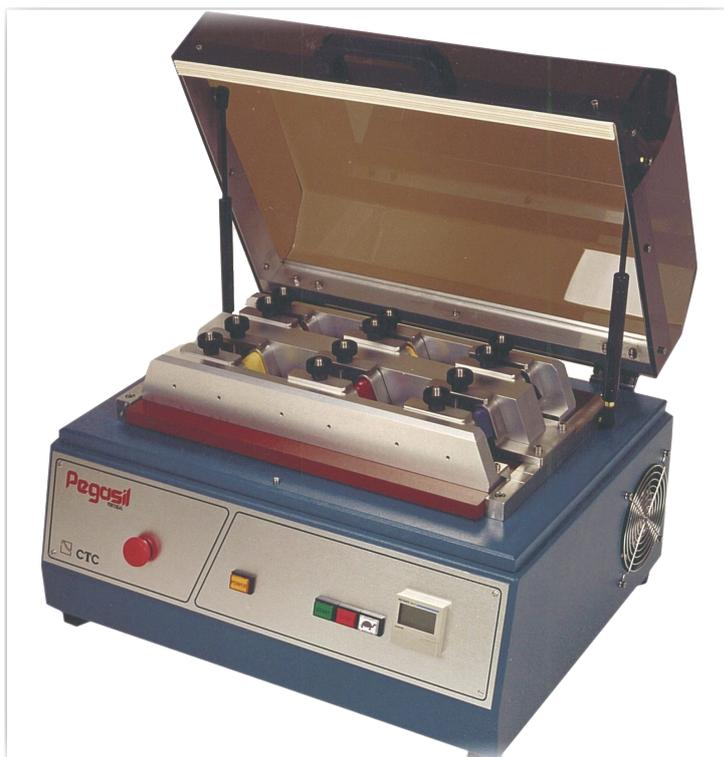
Le flexomètre VAMP est utilisé pour évaluer la formation de craquelures dans la zone de flexion de la chaussure durant son utilisation.
