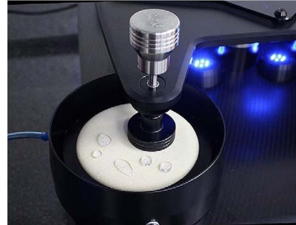
Le bain permet de tester des échantillons humides mais permet également de réaliser des tests sur des échantillons immergés.
