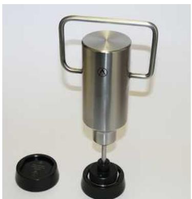
En utilisant le poids de 5,5 kg, il suffit de placer le poids sur la broche et serrer le support d'échantillon
