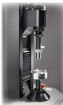
Ajustement de la vitesse de lame conformément à la nouvelle version de la norme EN 388
