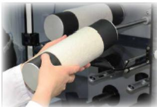
Les cylindres de porte-échantillons sont amovibles sans outils. Cela rend la mise en place du feutre extrêmement facile ainsi que le montage de l'échantillon.
