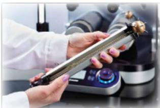
Le porte-échantillon a été conçu afin que l'utilisateur puisse évaluer la dégradation de l'échantillon et inspecter les pointes en toute sécurité.
