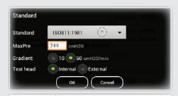
Contrôle précis et simple d'utilisation des paramètres de chaque norme : pression, gradient, tête.
