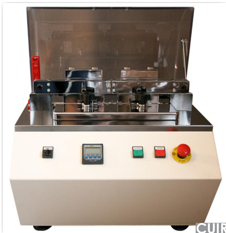
Le Scrubb permet de mesurer la résistance au froissement de tissus revêtus d'élastomères ou de matières plastiques. La partie flottante de l'échantillon est soumise au frottement d'un patin équipé d'une charge. Le contrôle de la dégradation est réalisé visuellement, après un certain nombre de cycles. L'équipement est livré avec 2 paires de patins largeur 10 et 11.5 mm et cale d'épaisseur 6 mm selon la version 2007 de la norme ISO 5981
