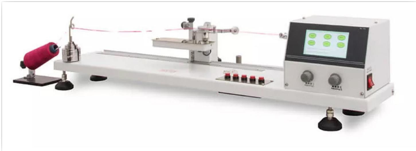
Appareil pour la détermination du nombre de torsions au mètre des fils simples et retors.
