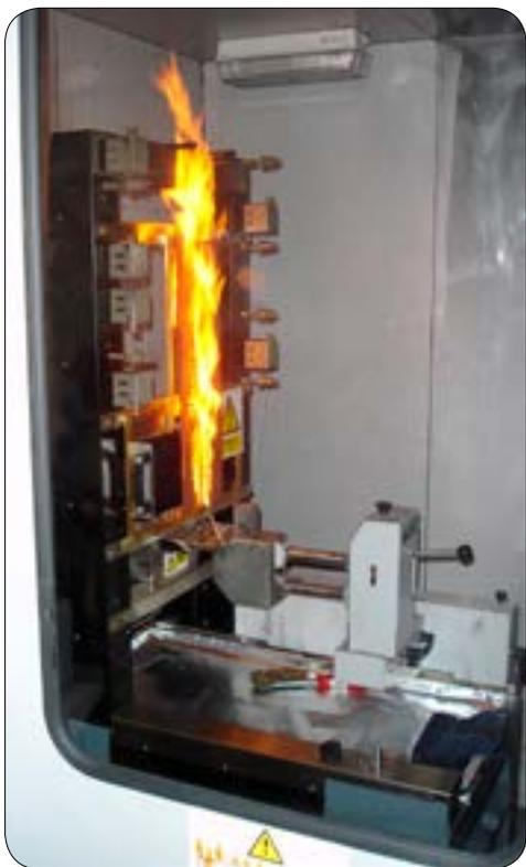
Chambre de test. Le Flexiburn est piloté par l'unité de contrôle
