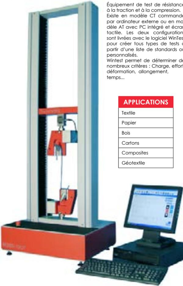
Équipement de test de résistance à la traction et à la compression. Existe en modèle CT commandé par ordinateur externe ou en modèle AT avec PC intégré et écran tactile. Les deux configurations sont livrées avec le logiciel WinTest pour créer tous types de tests à partir d'une liste de standards ou personnalisés. WinTest permet de déterminer de nombreux critères : Charge, effort, déformation, allongement, temps...
