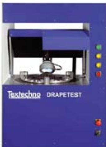
Le Drapester est un testeur de drapé automatisé qui permet de caractériser le drapé et la formation de défauts au cours de la mise en forme du matériau.
