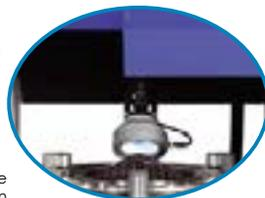
De la même manière, l'échantillon peut-être balayé par un capteur de triangulation en option afin de déterminer les défauts tels que les rides.
