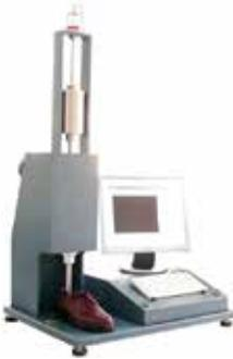
Équipement pour évaluer les propriétés d'absorption des chocs de matériaux d'assemblages.
