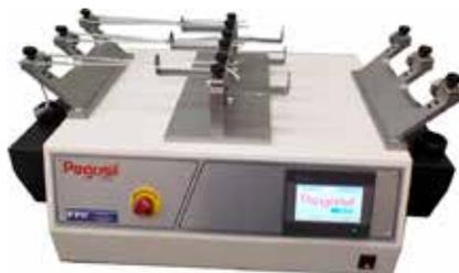
Appareil permettant de mesurer la résistance des lacets à l'abrasion, aux frottements répétés contre un autre lacet, un œillet ou un crochet.
