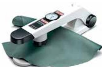
Ce test non destructif ne nécessite pas de couper les échantillons et permet de déterminer la souplesse d'un cuir.
