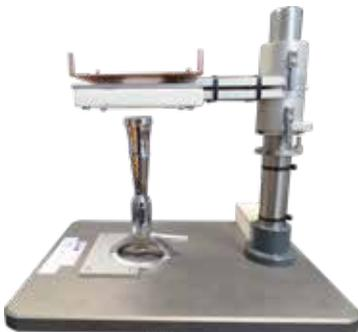
L'échantillon est soumis à la flamme d'un brûleur à gaz. La chaleur passant à travers l'échantillon est mesurée au moyen d'un calorimètre qui est en contact avec l'arrière de l'échantillon. Le temps de montée en température de 12° (HTI 12°) ou 24° (HTI 24°) est enregistré.
