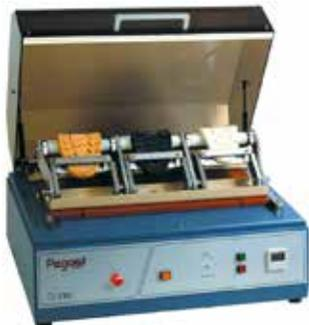
Cet équipement permet de déterminer la résistance à la flexion répétée des semelles (propagation d'une entaille). Il est équipé de 3 stations, composé d'une mâchoire fixe et d'une mâchoire mobile. La vitesse de mouvement de 140 cycles/minute à un angle de flexion de 90 ° avec présélection du nombre de flexion. Interrupteur pour arrêter l'échantillon dans les deux positions (position tendue pour fixer, position pliée pour mesurer le craquement de l'échantillon)
