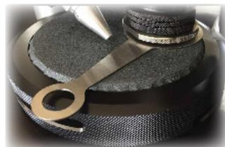
Chaque station de test est équipée de trois buses qui soufflent de l'air comprimé afin de maintenir un environnement de tests propres.
