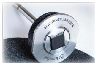
Chaque porte-échantillon peut recevoir des éprouvettes de différentes épaisseurs, conçus avec un dispositif de 4 mâchoires pour le fixer fermement.
