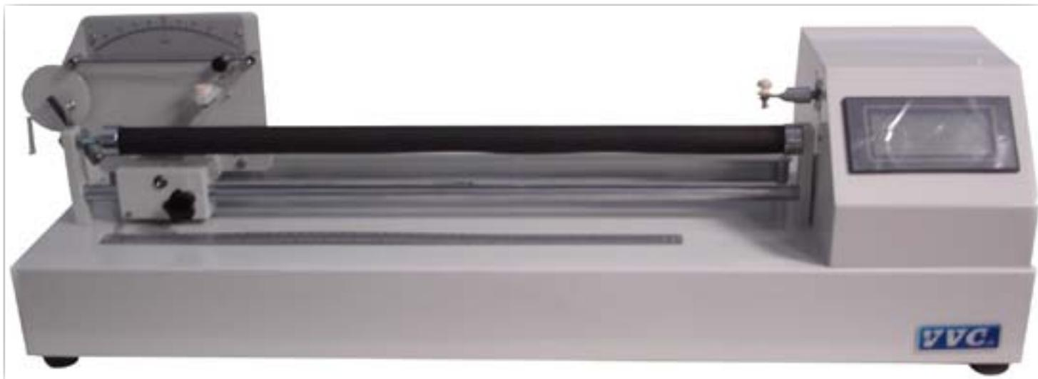
Un capteur inductif arrête automatique l'instrument la détorsion et rétorsion lorsque le test est terminé. Il est équipé d'un support cylindrique noir et d'une loupe utilisé pour vérifier le comportement du fil testé Longueur variable de 1 à 50 cm ( 1 à 20 pouces).
