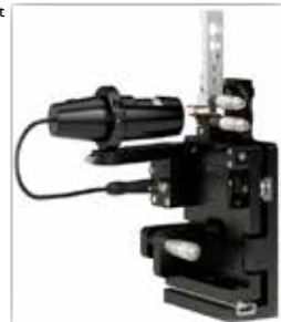
Accessoire du testeur FAVIMAT+ pour test Pull Out
