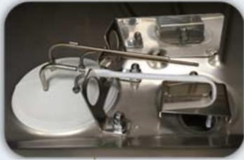
**Double sonde de régulation en Température**
