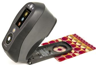
**Textiles.** Si des matières et des tissus peuvent paraître semblables à première vue, ceux qui contiennent des azurants optiques peuvent avoir une apparence totalement différente sous d'autres conditions d'éclairage. L'éclairage UV étalonné disponible permet de contrôler l'équilibre UV/visible, donnant lieu sur le long terme à des mesures cohérentes sur les échantillons optiquement clairs.
