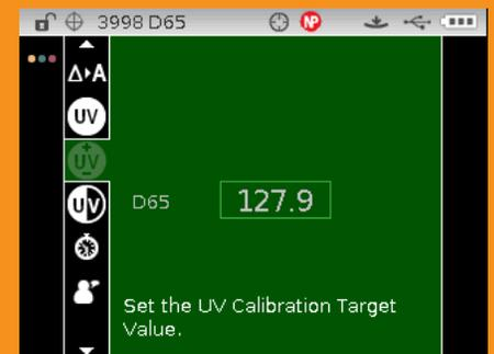
Composant UV étalonné : premier spectrophotomètre portable de X-Rite à disposer d'un composant UV réglable pour caractériser pleinement les matériaux contenant des azurants optiques.
