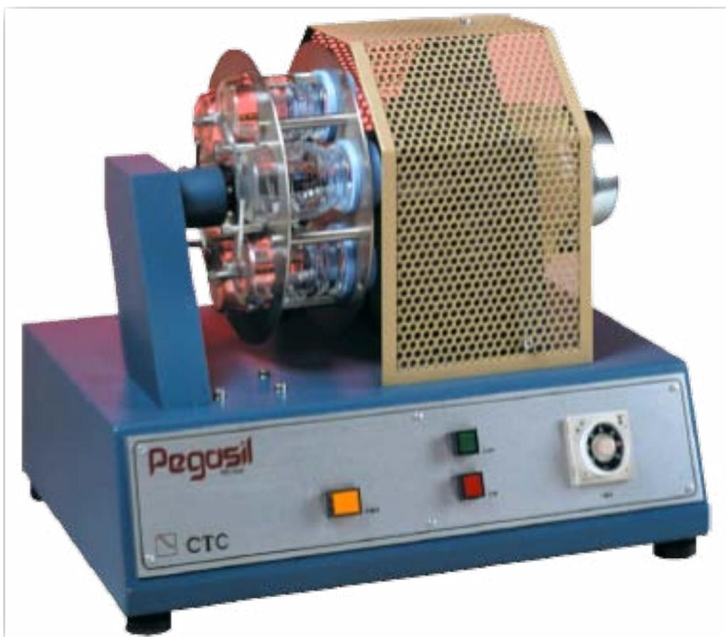
Cet appareil détermine la perméabilité à la vapeur d'eau (respirabilité) des cuirs naturels ou synthétiques utilisés pour le dessus (extérieur ou doublure).
