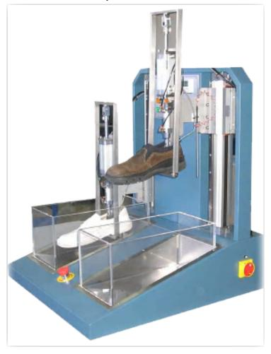
Cet essai est applicable à tous les types de chaussures et permet d'évaluer plusieurs aspects importants (par exemple: qualité des matériaux, de l'assemblage de chaussures, collage, ...).
