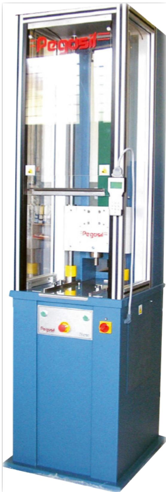
Le système d'impact qui est attaché à une base métallique solide et compacte comprend un percuteur d'un poids et d'une forme déterminée. Il est conçu pour tomber librement sur des guides verticaux d'une hauteur prédéterminée afin de donner l'énergie de l'impact.
