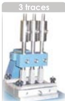
Cet équipement permet de déterminer le comportement de la surface d'un cuir au frottement (sec ou mouillé).
